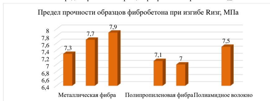
Рис. 2. Предел прочности образцов фибробетона при изгибе R_{изг}
