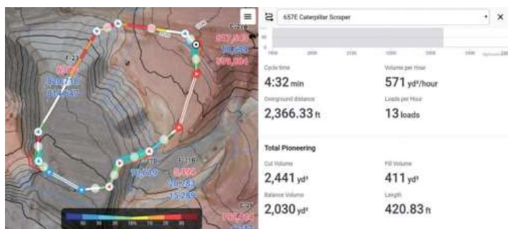
Рис. 3 Цифровая модель траектории движения скрепера
